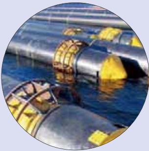
Tubos con los obturadores, conos delanteros y abrazaderas de remolcado colocados, listos para su envío (Montpellier, Francia, 2003)
